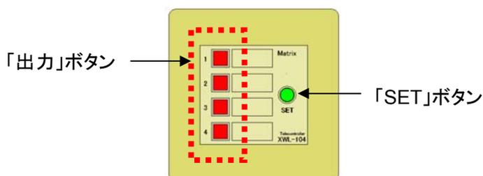
制御機器の出力をオンするには、制御機器が接続されている「出力」ボタンを押します。
