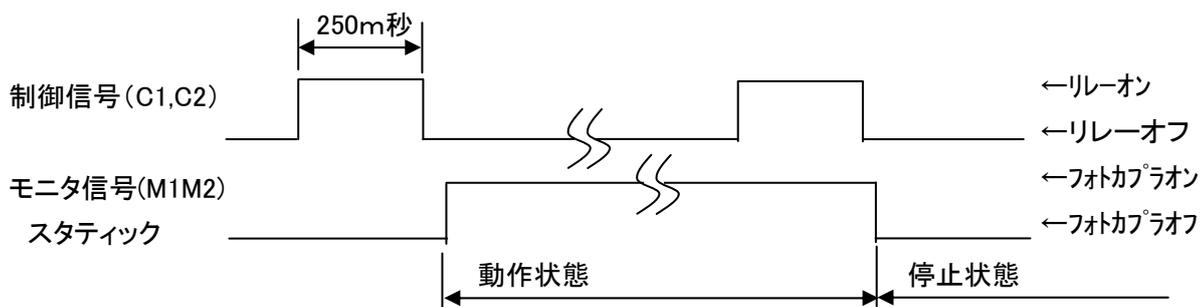
JEMA 端子は別名 HA 端子、JEM1427 端子とも呼ばれています。ルームエアコン、給湯機（風呂）、FF 暖房、床暖房、電動開閉機器、電気錠、電気温水器、照明器具などに使用されています。カタログに上記の端子名があれば制御可能です。
