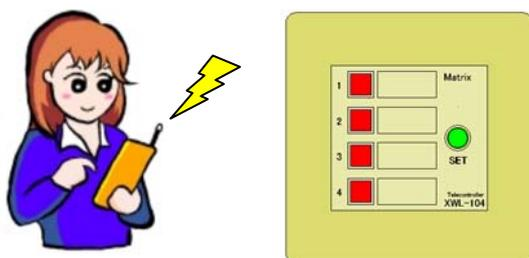
※本装置は、電話機のトーン信号(ダイヤルをする毎にピッポッパツのような音がして信号を伝えます)を感知して操作します。
