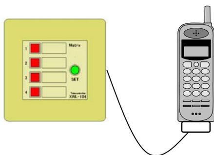
本装置と携帯電話を接続して遠隔操作する場合は、携帯電話の自動着信機能を使用して通話できるようにします。
